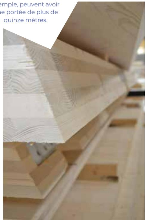
problème peut être résolu en collant les planches ensemble. Le collage se fait de différentes manières et donne par exemple le glulam (bois laminé collé), le CLT (cross laminated timber, bois laminé croisé) et le multiplan (bois multicouche). En conséquence, les structures modernes en bois peuvent avoir une portée de plus de quinze mètres et n'ont pas de performances inférieures à l'acier ou le béton.
