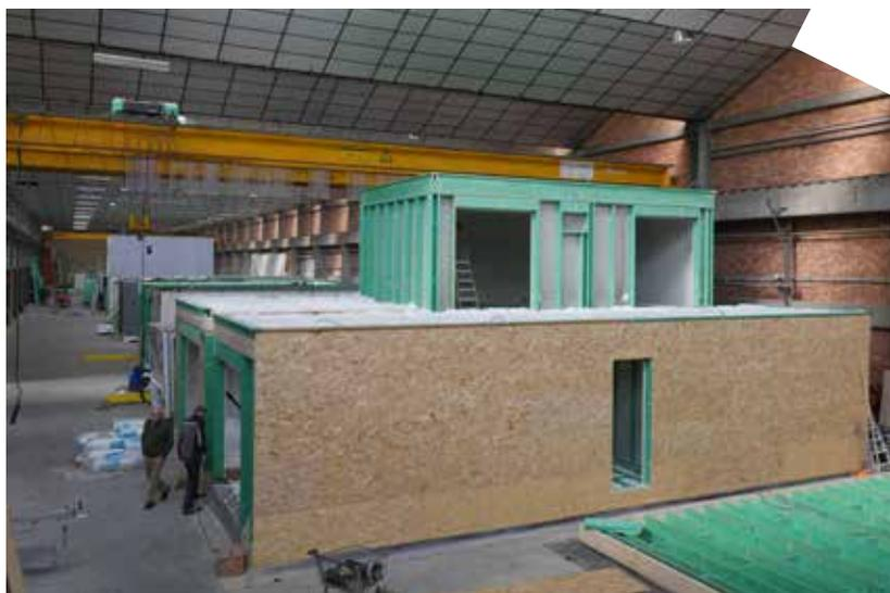
Les parties innovantes de la construction ont également adopté à nouveau la préfabrication. Dans l'usine, les éléments de construction sont construits de manière à ce que les entrepreneurs puissent construire les maisons rapidement.
